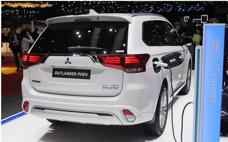
*Posibilidad de conducción totalmente en modo eléctrico con una autonomía reducida (25-60 kms). La batería se carga enchufando el vehículo a la red eléctrica.*
